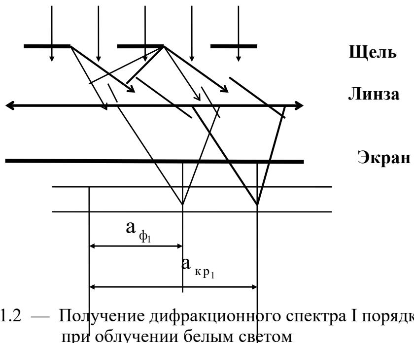
Рисунок 1.2 — Получение дифракционного спектра I порядка при облучении белым светом
