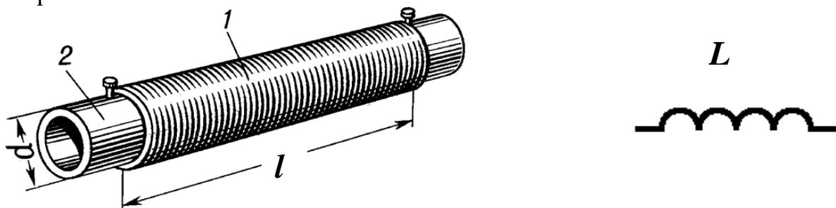
Рисунок 1 Катушка индуктивности с сердечником:
