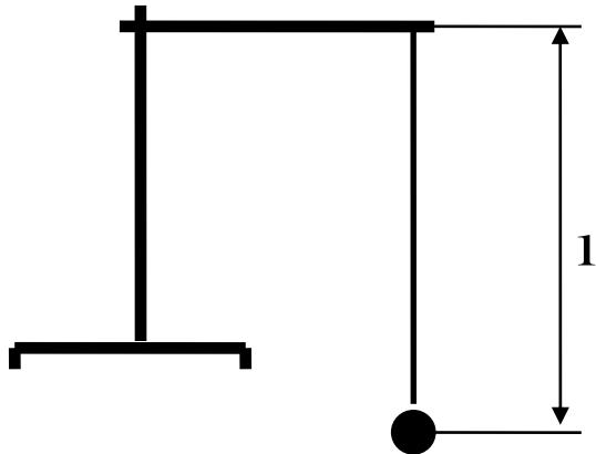
Рисунок 3.1 – Схема опыта по определению ускорения свободного падения.
