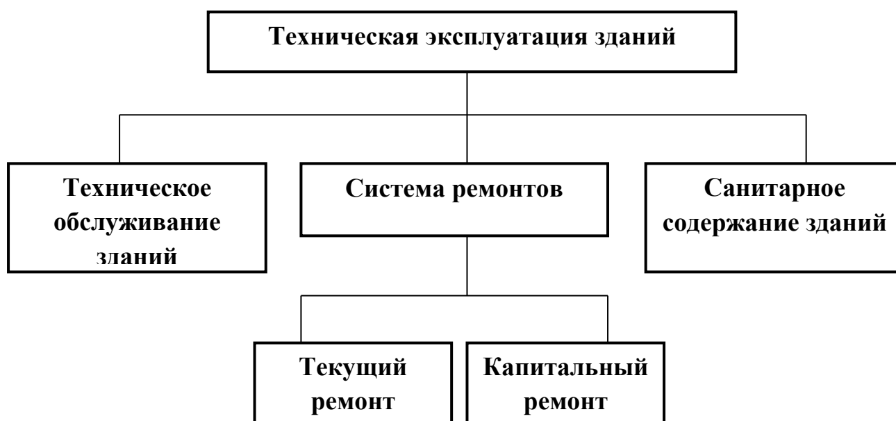
Схема 1. Система технической эксплуатации зданий
