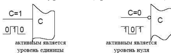
Рис.1.Статическое (потенциальное) управление
