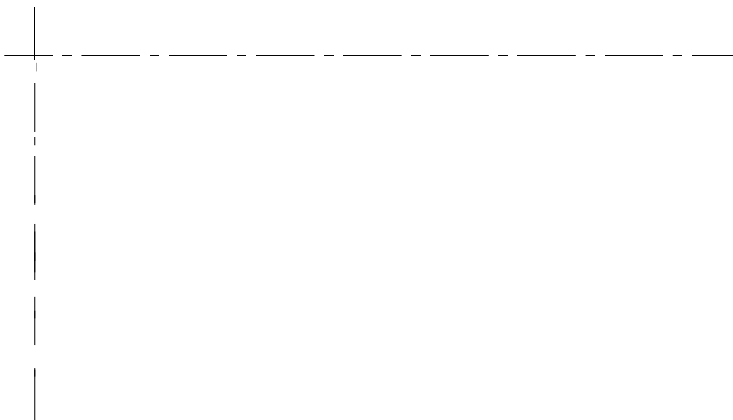
Рисунок 36 – Вычерчивание координационных осей
