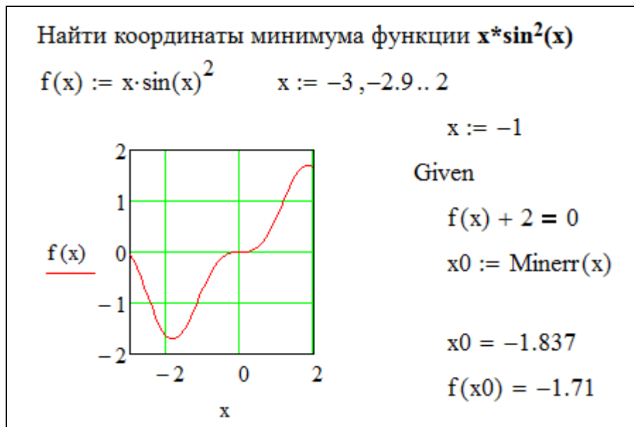
Рисунок 2.2 - Пример нахождения минимума функции одной переменной
