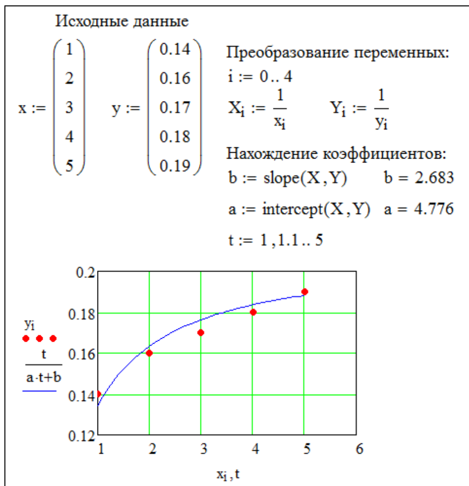
Рисунок.4.3 - Аппроксимация данных зависимостью y = x/(a \cdot x + b)
