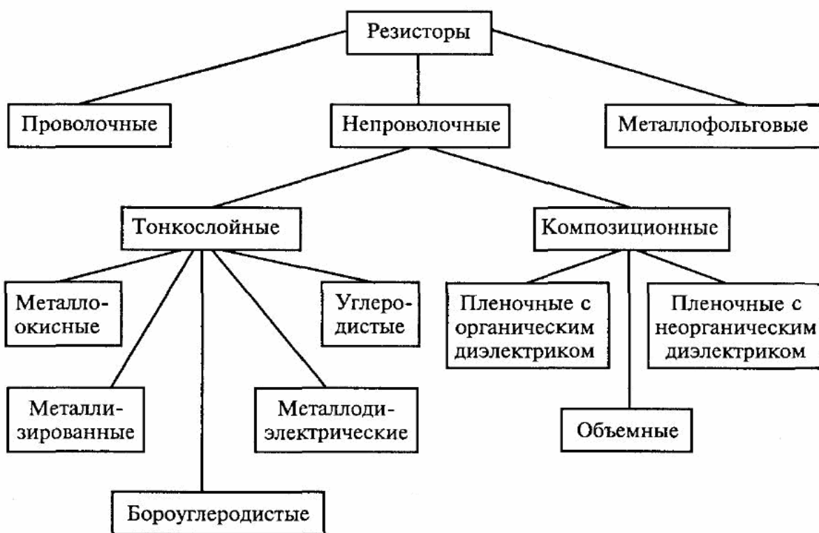
Рисунок 3 - Классификация резисторов по материалу резистивного элемента
