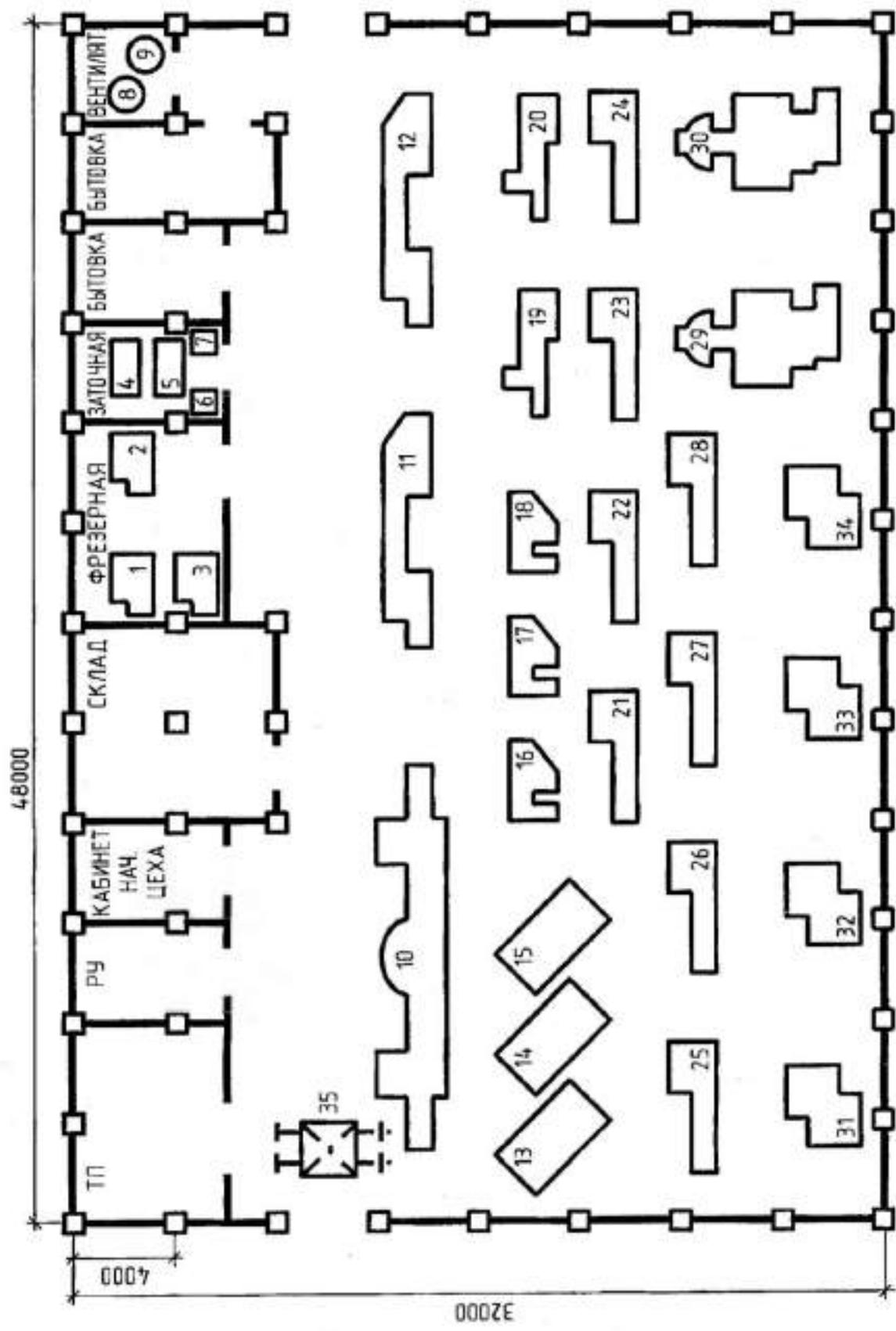
Рис. 3.7. План расположения ЭО механического цеха серийного производства
