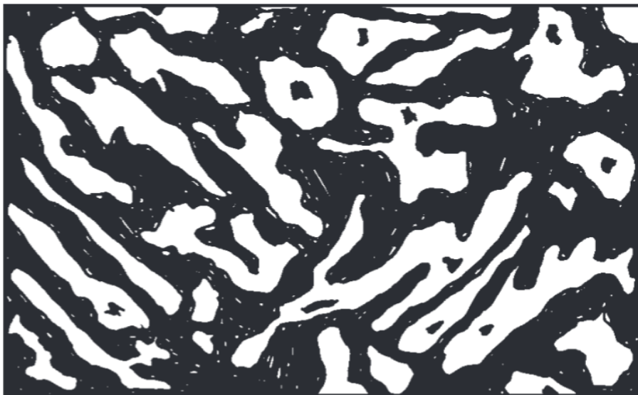
Рис.2. Латунь ЛС59-І: \alpha и \beta - фазы и включения свинца, х450
