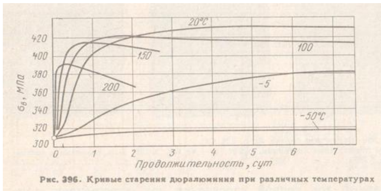
Рисунок 15.4 – Изменение прочности сплавов системы Al-Cu в зависимости от температуры и продолжительности старения
