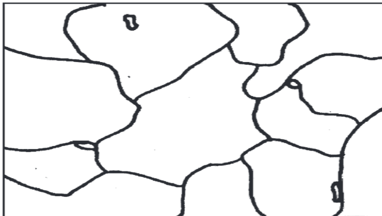
Сплав МЛ5 (после термообработки): \delta - фаза и включения \gamma - фазы, ч450
