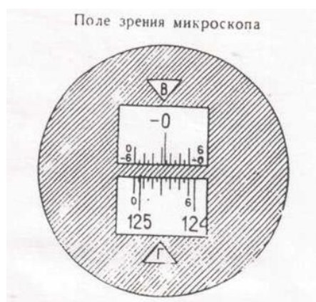
Рисунок 7 - Показание лимба горизонтального круга 125^{\circ}05,5'
