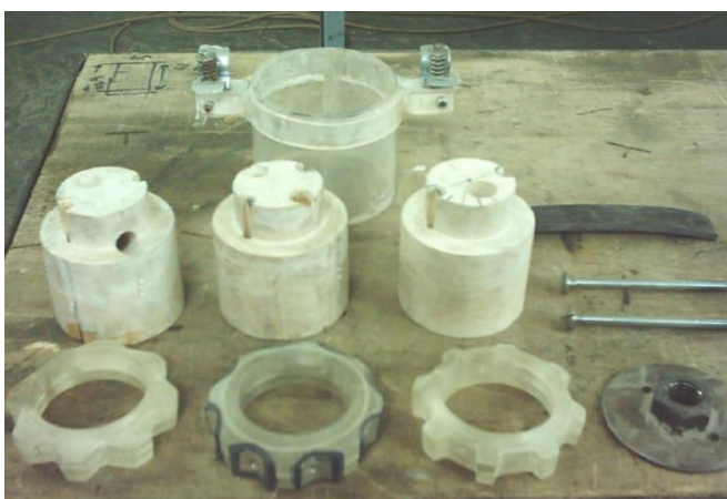
Рисунок 10 – Макеты корпуса и конфигураций промывочных пазов Хруцкого А.А.
