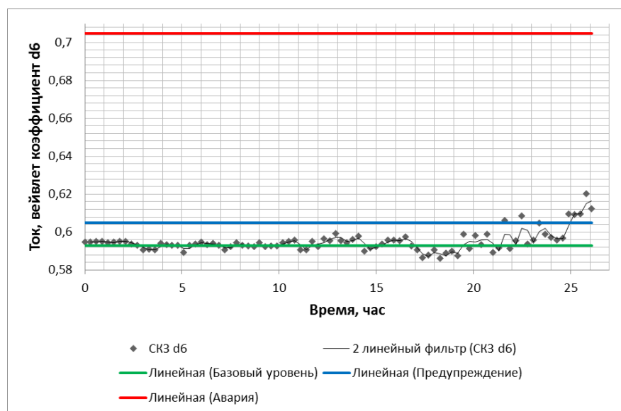
Рисунок 2 – Результаты экспериментальных исследований с установленными уровнями состояния при отсутствии смазки в редукторе в течение 26 часов: а) СКЗ вейвлет-коэффициента d5 виброускорения и его тренд; б) СКЗ вейвлет-коэффициента d6 тока и его тренд
